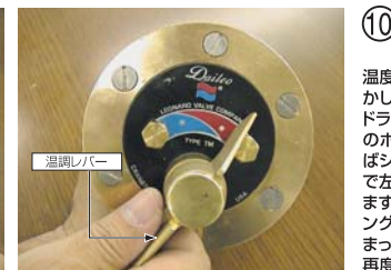
⑨ カバーに取り付けているバイメタルサーモの凸部の先端(ドライビングボール)をシンプルのボールソケット部に確実に差し込んで下さい。
