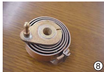
⑧ バイメタルコイルの表面が黒くなったりしている場合、家庭用の酢に20分程度つけて下さい。取り出した後は水洗いして下さい。 ※腐食がひどい場合は交換が必要です。
