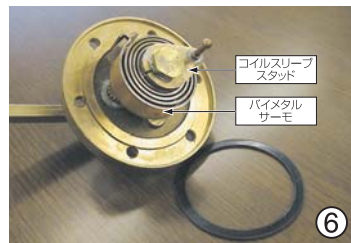
⑥ カバーの裏側に温度調整する為のバイメタルサーモを取り付けています。
