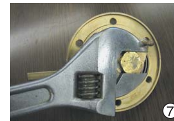
⑦ コイルスリーブスタッドをモンキーレンチで反時計方向に廻して取り外します。
