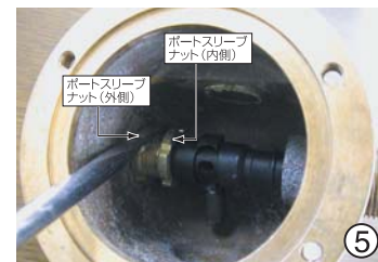
⑤ ポートスリーブナット(内側)を反時計方向に廻し軽くマイナスドライバーでたたきながら固定して下さい。最後にポートスリーブナット(外側)を時計方向に廻しロックします。
