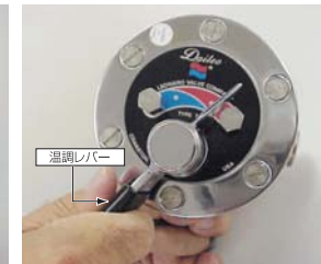
⑩ 温度調整レバーを左右にすばやく動かして下さい。バイメタルサーモのドライビングボールが確実に本体部のボールソケットに挿入されていればシンプルが温度調整レバーを動かす事で左右に動き、カチカチと音がします。全く音がしない場合、ドライビングボールがボールソケット部にハマっていない場合がありますので、再度カバーを外しご確認下さい。
