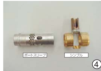
④ シンプルの内側とポートスリーブの外側に付着したスケールなどをクレンザーなどで落として下さい。腐食がひどい場合は交換して下さい。
