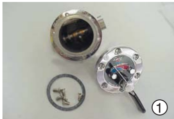
① マイナスドライバーで6本のビスをはずします。
