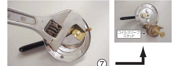
⑦ コイルスリーブスタッドをモンキーレンチで反時計方向に廻して取り外します。
