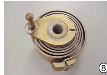
⑧ バイメタルコイルの表面が黒くならしている場合、家庭用の酢に20分程度つけて下さい。取り出した後には水洗いして下さい。 ※腐食がひどい場合は交換が必要です。
